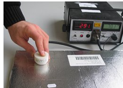
Abb.: 5.12 Messung mittels Va-Q-check ® -Verfahren
