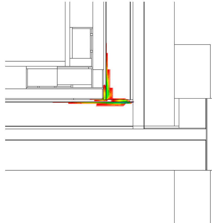
Bereiche negativer Dampfdruckdifferenz im Detail Innenecke Grafik: Erstellt mit ANTHERM, T. Kornicki
